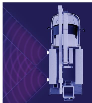
Los camiones de servicio o los camiones con pluma pueden considerar montar las lámparas en dos lugares del vehículo para que converjan en el punto central y aseguren la máxima cobertura e iluminación de la zona de trabajo.
