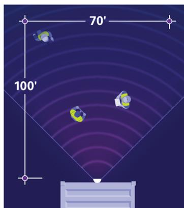
Les lampes WorkShield de Grote créent une zone de travail triangulaire d'environ 3 000 pieds carrés. Il est important de s'assurer que les lampes sont montées de manière à ce que les travailleurs (et le matériel à haute visibilité) opèrent au centre de cette zone de travail. Cela garantira une visibilité maximale.
