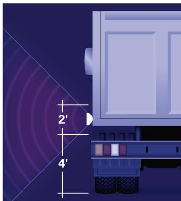
Il est recommandé que les lampes WorkShield de Grote soient montées à une hauteur comprise entre 48" et 72" du sol.
