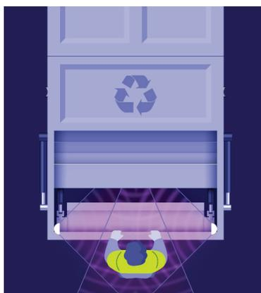
Pour les applications où des travaux ont généralement lieu derrière le véhicule, comme sur les camions de recyclage ou les dépanneuses, nous recommandons d'installer deux unités WorkShield de Grote pointant vers l'intérieur vers le centre de l'arrière du véhicule.
