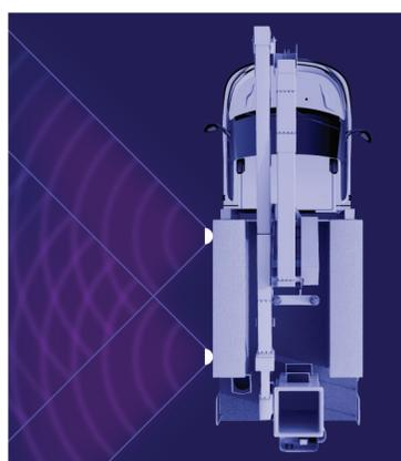
Les camions de service ou les camions-grues peuvent envisager de monter les lampes à deux endroits du véhicule afin qu'elles convergent vers le point central et assurent une couverture et un éclairage maximum de la zone de travail.
